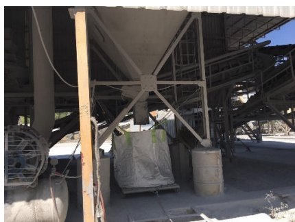
รูปที่ 2-12: การกำจัดฝุ่นแบบระบบถุงกรอง (Bag Filter)
